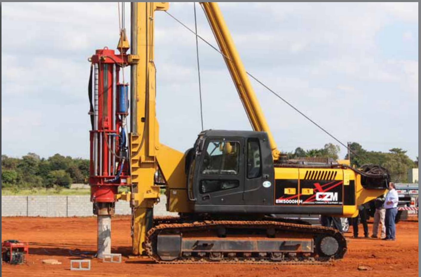
O bate estacas EM5000HH utiliza um martelo hidráulico Fambo-Bauer de pilão de 5.000kg. The CZM EM5000HH uses a Fambo-Bauer hydraulic Hammer of 11.000lb drop weight.
